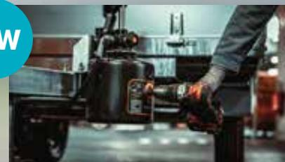
La Flexipump permet de basculer un plateau ou une benne avec une visseuse
