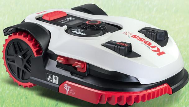
Encore plus de surface couverte et plus de fonctions intelligentes : les modèles Mission KR121E, KR122E et KR123E sont équipés du système breveté de capteur à ultrasons OAS. Ils détectent les obstacles à l'avance et prennent des mesures pour les éviter.
