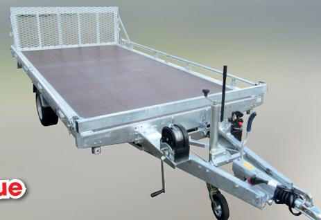
Présenté avec options : kit hydraulique de basculement, hayon, treuil et main courante (voir prix en magasin)
