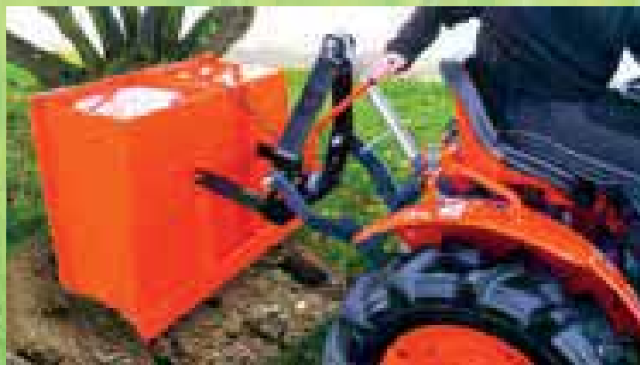
BENNETTE 100 Basculement mécanique. Porte arrière à double ouverture. Lame rabet. Capacité de charge 300 kg. Largeur 1 m : 70 kg.
